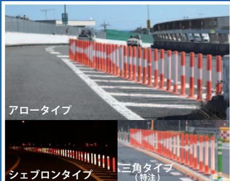
車線分離標の反射シート部分で矢印などを表示し進行方向を示して逆走を防止
